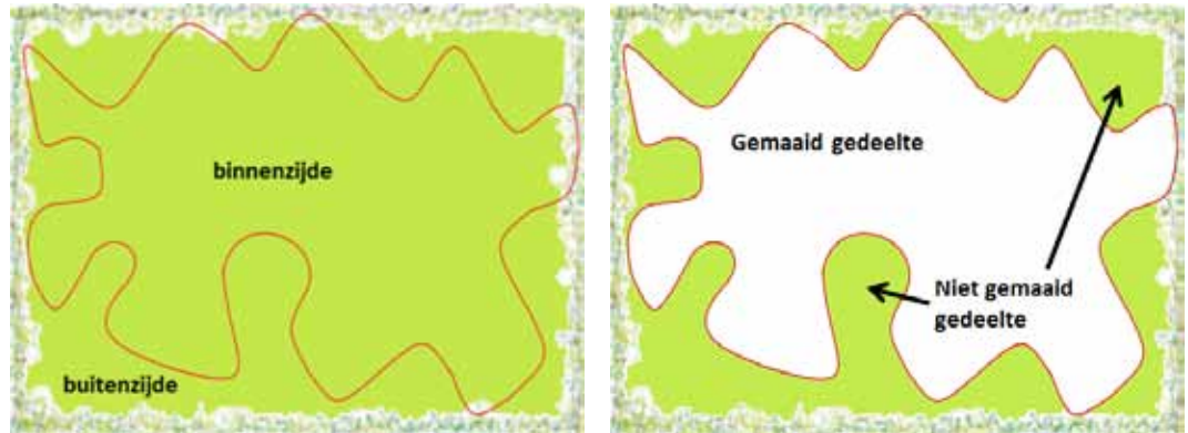
Figuur 3-4 Het sinuspad (rode lijn) creëert een binnenzijde en een buitenzijde. Het is die binnenzijde die zal gemaaid worden terwijl de buitenzijde niet wordt meegemaaid.
