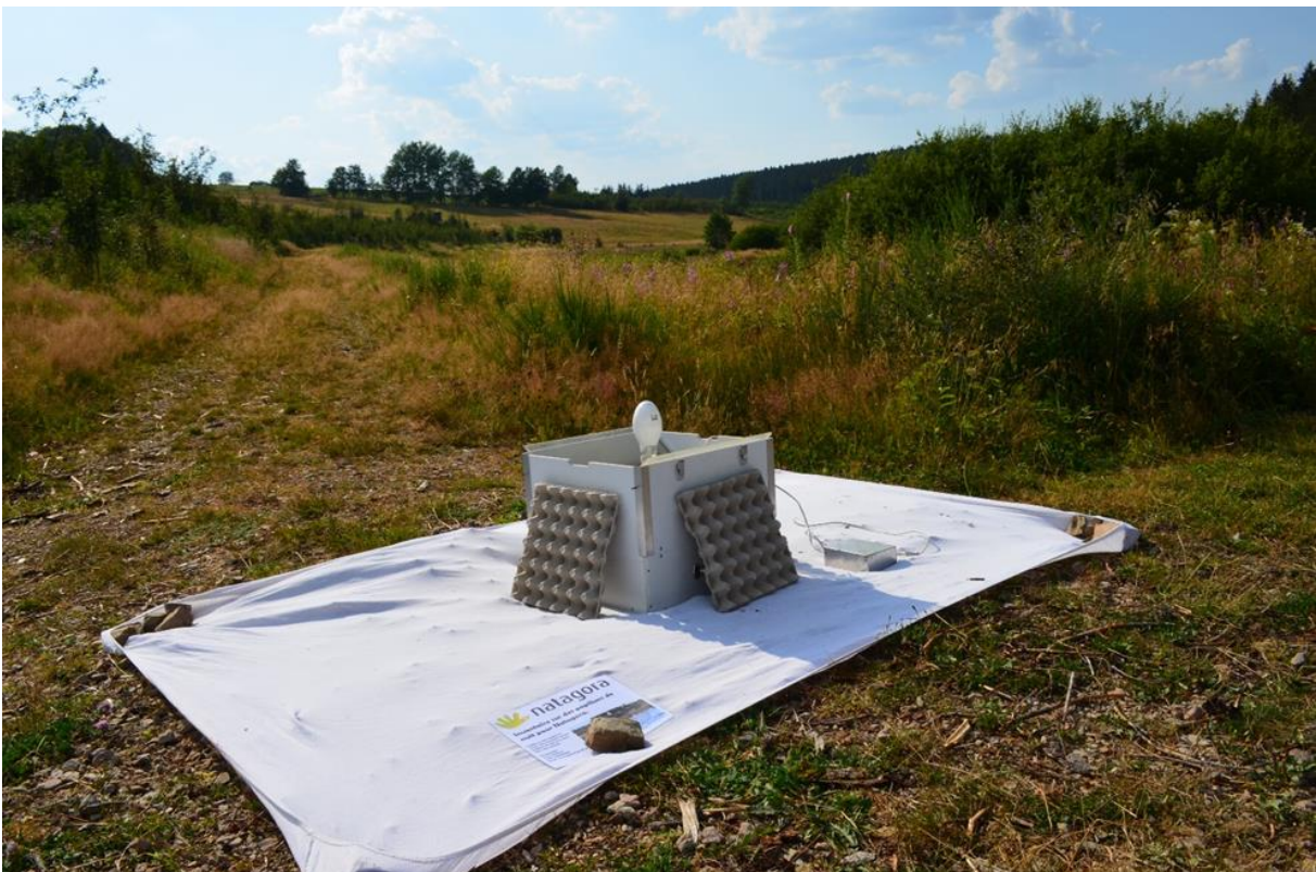
Fig. 6. Vangopstelling met 125 W lamp. België, Rocherath, 'Vallei van de Holzwarche' (LG), 08.viii.2020. © Steve Wullaert.
