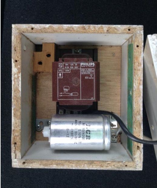
Fig. 7. Volledig gemonteerd systeem met ballast en condensator (deksel verwijderd). © Theo Garrevoet.
